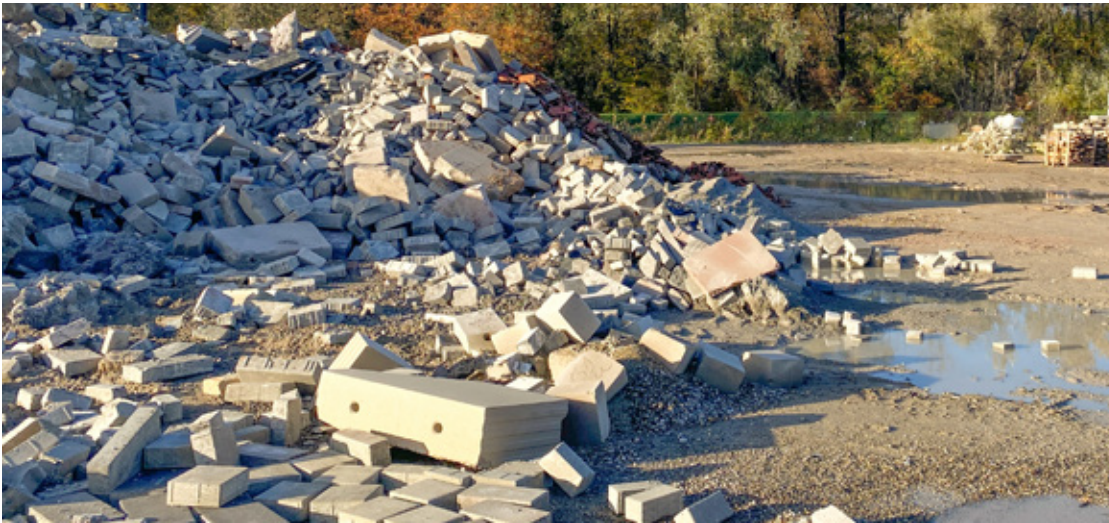
Kalksandstein-Abbruchmaterial – Rohstoff für das Bauwesen.
