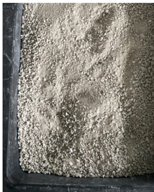
Kalksandstein-Recyclingmaterial mit anhaftenden Resten an Gipsputzmörtel.
