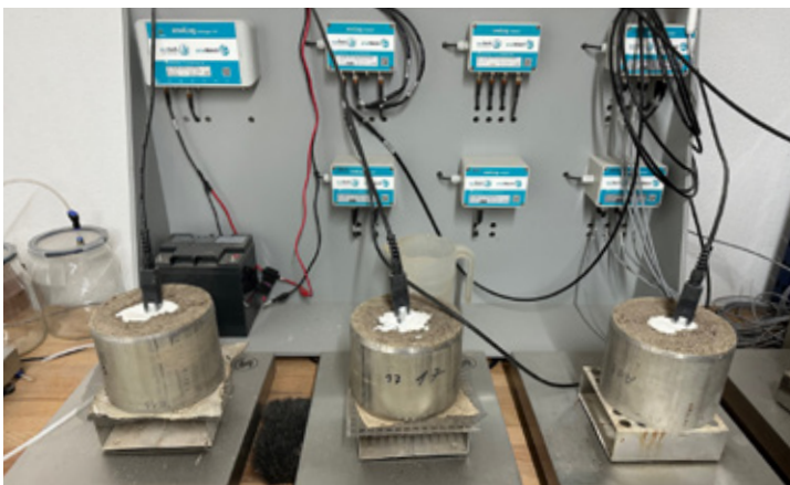
Messapparatur zur Bestimmung der Porosität von Kalksandstein-Rohlingen.
