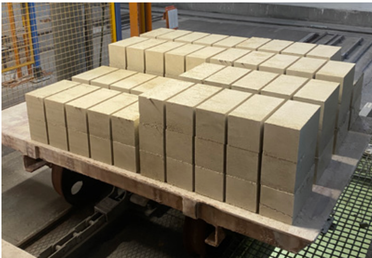
Kalksandstein-Rohlinge mit Betonbrechsand im Werksversuch.
